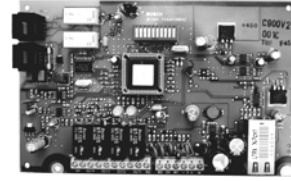
C900V2 → Dialer-Capture Ethernet Module
